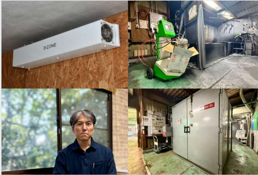
右上/グリーンの設備から静電気を発生させ粉体を送り出す 右下/導入した最新式の排熱回収型ガス熱風乾燥システム 左上/粉体塗装による空気清浄機 左下/代表取締役の佐藤 貴寿氏
