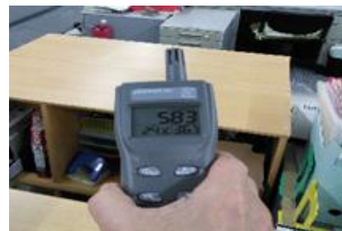
＜室内環境の測定（CO 2 計）＞
