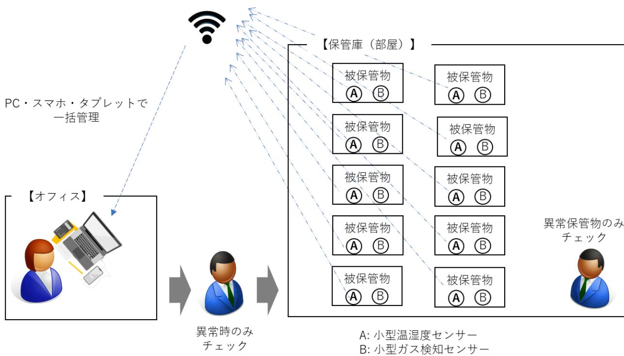
一方、技術の進歩による小型センサー類と IT 技術を駆使し、上図のようなモニタリングシステムを構築すれば、これまでの保管管理方法とは違う省人化、効率化、異常検知の迅速化をなし得る事ができると考えている。
