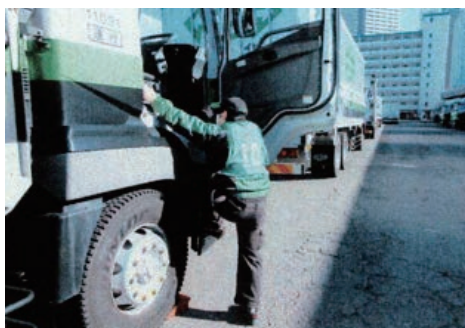
墜落・転落防止:三点支持の徹底
