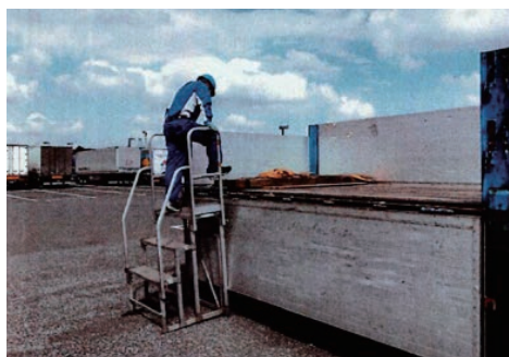
墜落・転落防止:昇降台の導入
